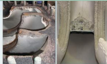
Pitting en slijtage was duidelijk Reparatie volledig uitgesleten oppervlak
