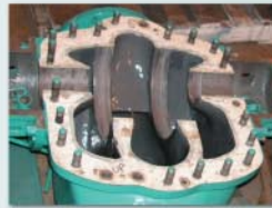
Pitting en slijtage was duidelijk Reparatie volledig uitgesleten oppervlak
