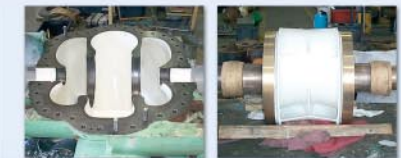
Repareer de uitgesleten en gecorrodeerde as met Loctite® 3478 Superior Metal. Nadat het uitgehard is, machinaal bewerken om de reparatie te voltooien. Al de onderdelen coaten met Loctite® Nordbak® 7227 Kwastbare Keramiek Wit (gecertificeerd voor gebruik met drinkwater)
