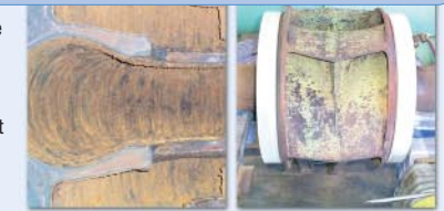
Bovenste sluiting en bronzen waaier voor reparatie. De eerste stap is om deze onderdelen abrasief te stralen tot SA-3 blank gestraald met 75µm profiel
