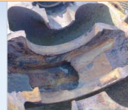
Afb. 1: Corrosie en erosie waren overduidelijk
