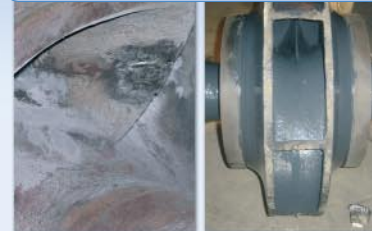
Waaier en behuizing voor reparatie. Ernstige slijtage en cavitatie op de waaier
