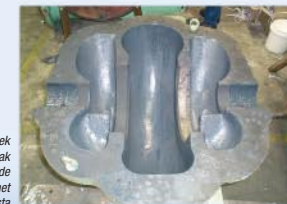
Repareer de uitgesleten en gecorrodeerde as met Loctite® 3478 Superior Metal. Nadat het uitgehard is, machinaal bewerken om de reparatie te voltooien. Al de onderdelen coaten met Loctite® Nordbak® 7227 Kwastbare Keramiek Wit (gecertificeerd voor gebruik met drinkwater)
